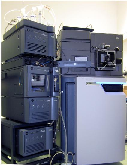
**Waters 2D-nanoUPLC und Synapt G2-S** : Ermöglicht hochauflösende Trennung mittels nanoUPLC und eine reproduzierbare label-freie quantitative Proteomanalytik.
